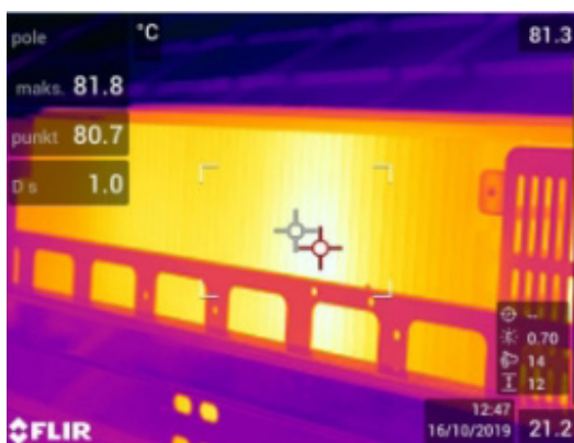
Radiator falownika pracującego w upalny dzień
